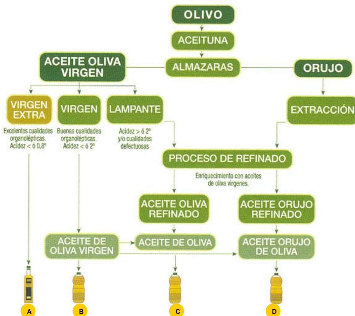
Cuadro Nº2 Diagrama del proceso productivo de los diferentes Aceites de Oliva
